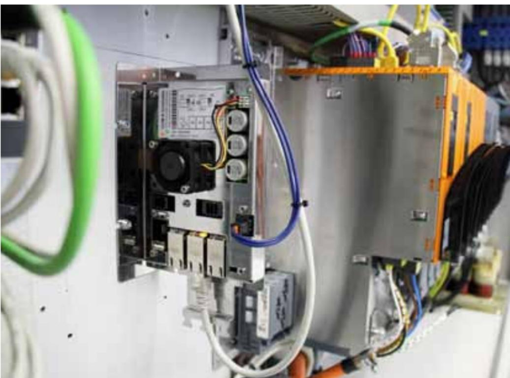
Ansicht des im Schaltschrank der Spritzgießmaschine eingebauten Routers
