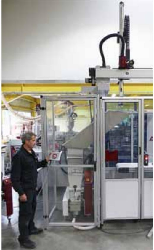
G-Max Mühle in der Schutzeinhausung einer Arbeitszelle
