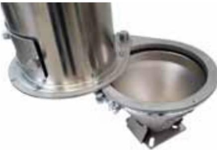
Schwenkbarer Maschinentrichter für einfache Reinigung
